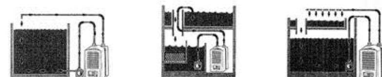
①水槽外部の循環ポンプ連結 ②過濾器内部の循環ポンプ連結 ③水槽内部の循環ポンプ連結
